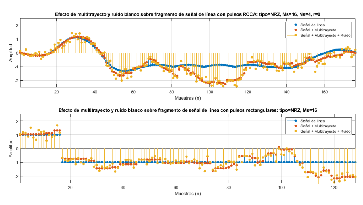
Figura 16. Efecto de multitrayecto ( P_{max}=20 , T_{max}=50 , \sigma=0.2 , N_t=5 ) y ruido blanco ( N_0=1e-7 ) sobre señal de línea.
